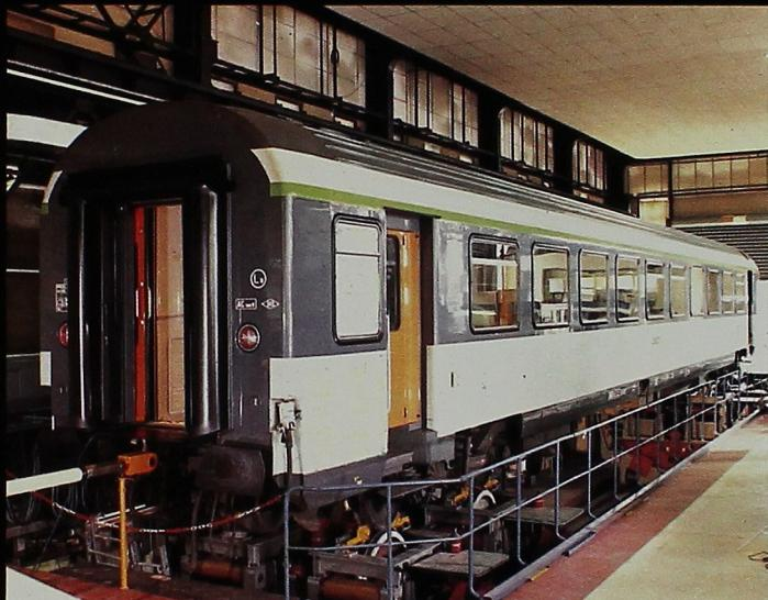
Banc d'essai dynamique des suspensions
