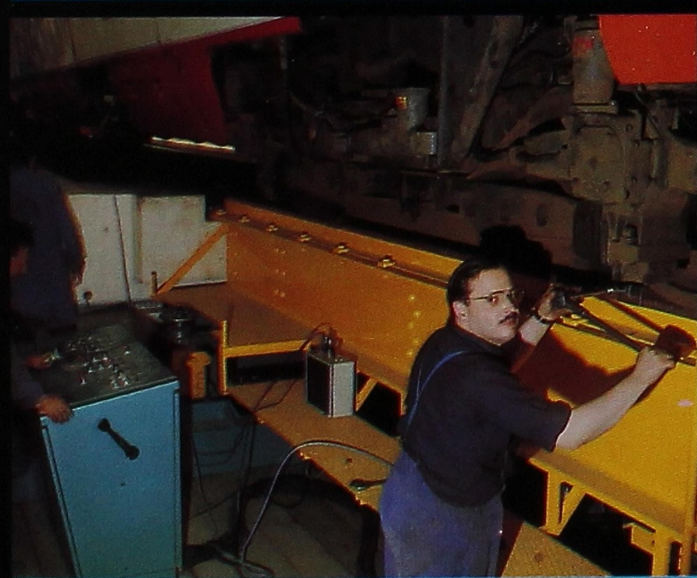
Mesure du couple de rotation caisse-bogie
