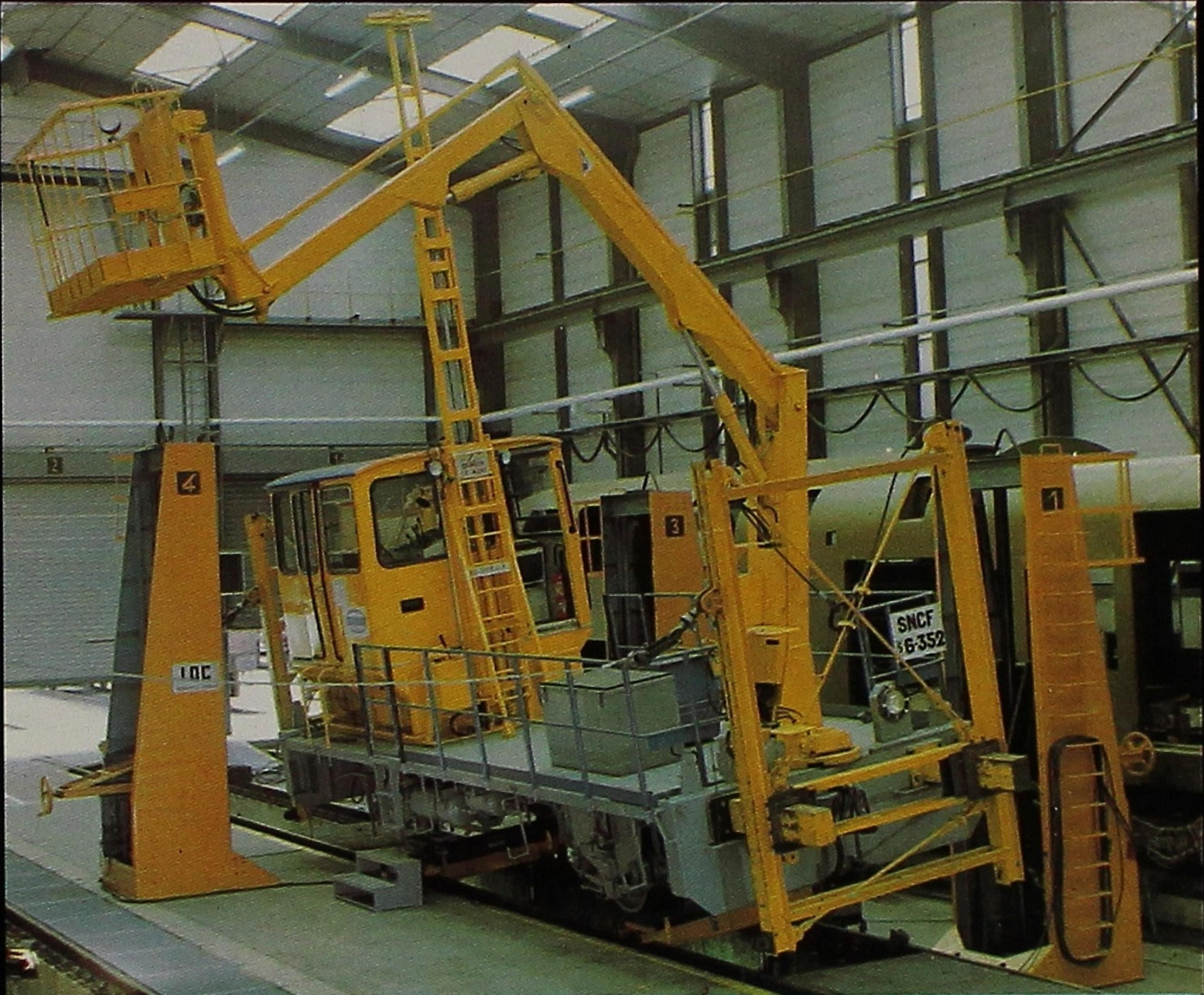
Vérification de l'aptitude d'un véhicule spécial à supporter des sollicitations transversales
