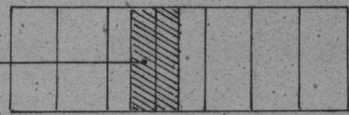
2°) plier à 90° les 2 bords de la surface coupée, sur une largeur de 45 mm., à l'aide de l'outillage à main.
