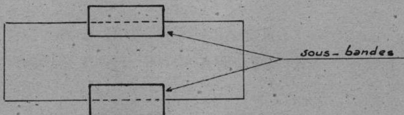
4°) Préparer une bande de « rubafer » égale à la surface à remplacer, avec plis à 90° de 35 mm. de largeur sur toute la longueur des 2 grands côtés.
